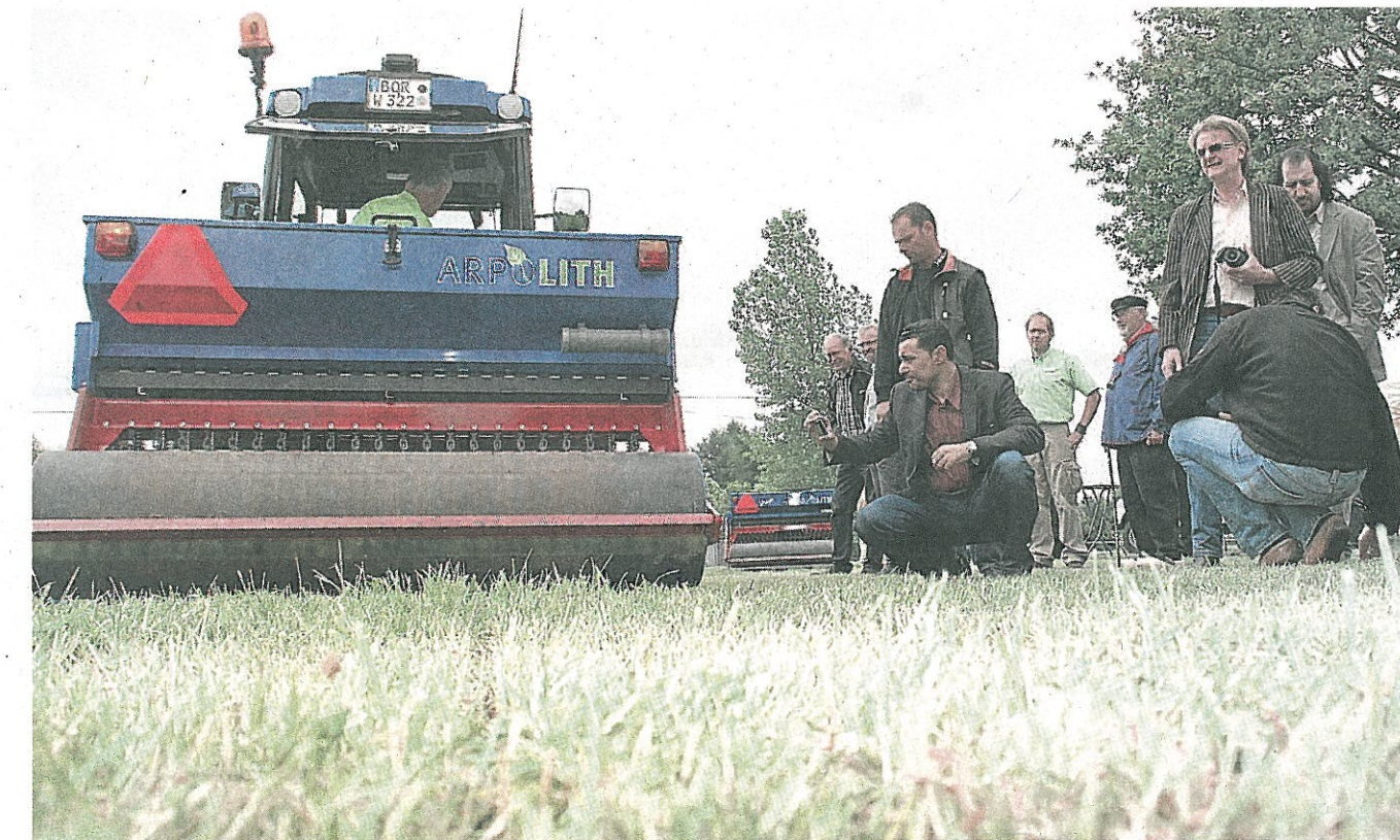
Das Fachpublikum schaute genau hin, als das Granulat in den Boden des Gemenwirth Schützenfestplatzes eingearbeitet wurde. Als Wasserspeicher soll es Gras und Bäume gleichmäßig feucht halten.
