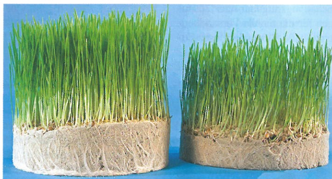
Arpolith im Rasentest: Links Quarzsand mit dem Vulkansteingranulat, rechts ohne Granulat nach vier Wochen in einer Glasschale. Verwendet wurde eine Standard-Rasenmischung.
